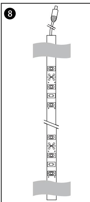
**Ágy alatti elhelyezés** Helyezze el az összecsatolt elemeket az ágya alá, majd bizonyosodjon meg róla, hogy az adapter megfelelően van csatlakoztatva. Mielőtt üzembe helyezi a szenzort és a LED szalagokat, válassza le a ragasztós védőréteget. Lásd: 6. kép
