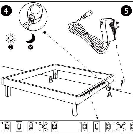
**Positionierung des Sensors** Wählen Sie einen Ort für den Sensor, wo Bewegung bzw. Hintergrund richtig erkannt werden können. Empfohlene Position, A und B. Siehe: Bild 4.
